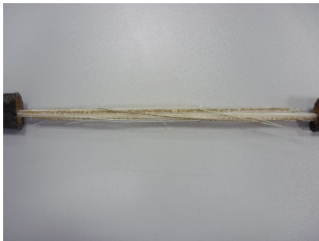
Рис. 3. Характер разрушения композитной арматуры
