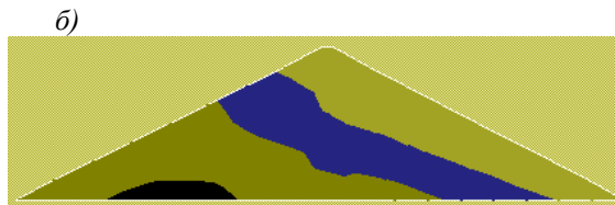
Рис. 2. Распределение главных (растягивающих) напряжений - \sigma_1 в плотине: без гидростатического давления (а) и с учетом гидростатики (б) при горизонтальных колебаниях, МПа: 0,032÷0,71 (белая зона); 0,71÷1,42 (серая); 1,42÷2,53 (черная)
