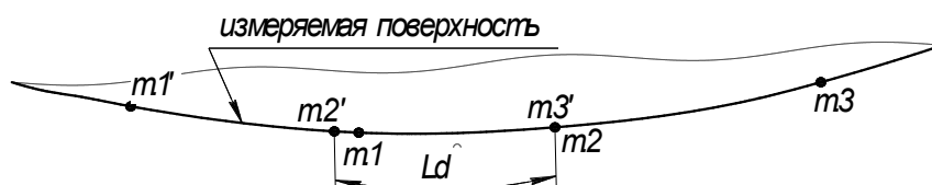
Рис. 2. Графическая интерпретация принцип последовательности измерений (точки m.1' , m.2' и m.3' соответствуют точкам контакта измерительных опор с поверхностью в предыдущем положении; точки m.1 , m.2 и m.3 соответствуют точкам контакта измерительных опор с поверхностью в текущем положении; Ld – длина дуги между точками m.2' и m.3' )
