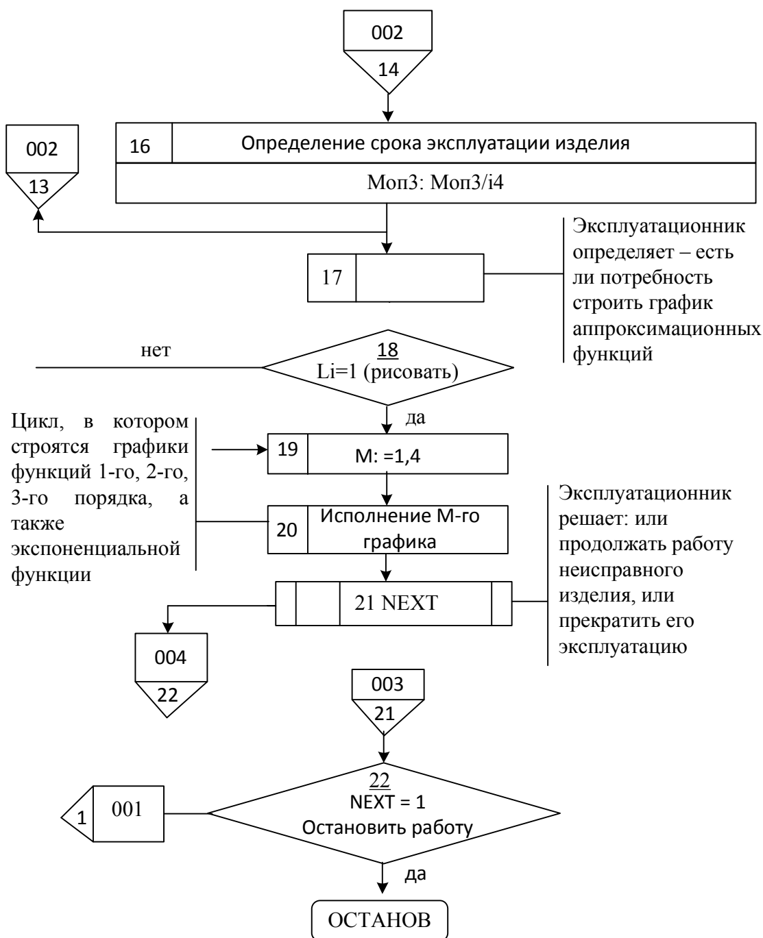
Рис. 1. Укрупненный алгоритм функционально-технического состояния ТА вследствие износа ее запорной части
